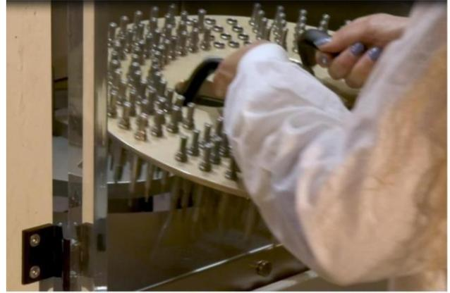
为了提高生产效率，我们提供了一套可互换的零件托盘，以及AF108系统，用于喷砂介质回收和自动填充喷砂罐。
